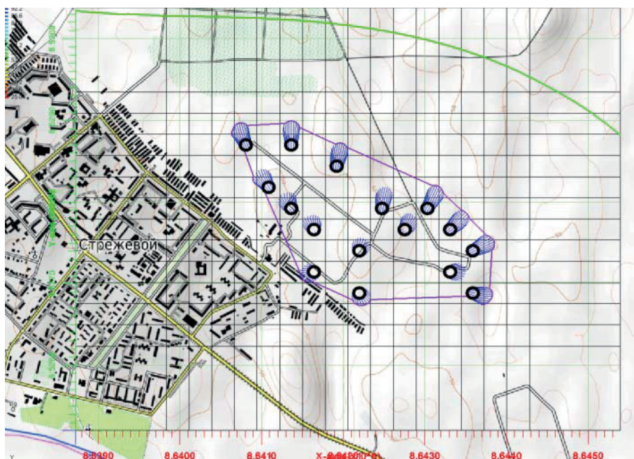
Рис. 15. Размеры зоны захвата фильтрационного потока на расчётный срок 10000 сут при суммарной производительности 5120 м³/сут.
