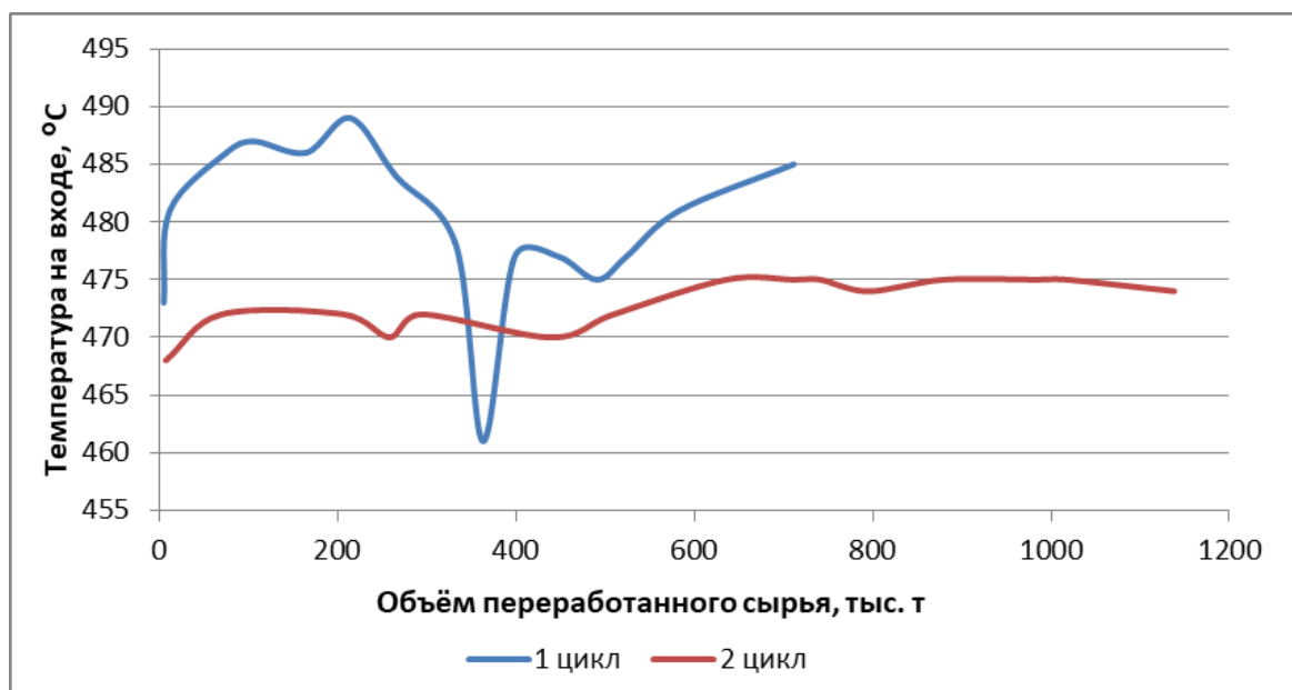
Рисунок 36. Изменение температуры в реакторах в разных сырьевых циклах
