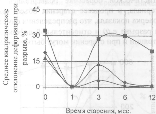
Рис. 3. Зависимость среднего значения (а) и среднего квадратического отклонения (б) относительной деформации при разрыве от времени старения (г. Томск) для термопластов на основе полипропилена: 1 – МПП 15-04, бесцветный; 2 – МПП 15-04, черный; 3 – БСПЭ 22007 – 16
