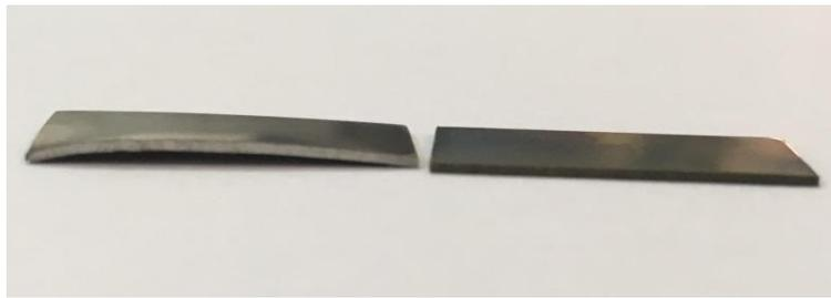
Рисунок 17. Внешний вид образцов после электроэрозионной резки (справа) и резки гильотиной (слева)
