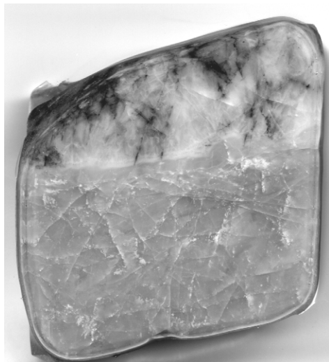
Рис. 1. Кварциты глубоких горизонтов — черного цвета (а), кварциты зоны гипергенеза — белого цвета (б), кварциты зоны трещиноватости — буроватого и серого цвета, с развитием по многочисленным разнориентированным трещинам гидроокислов железа и марганца (в)
