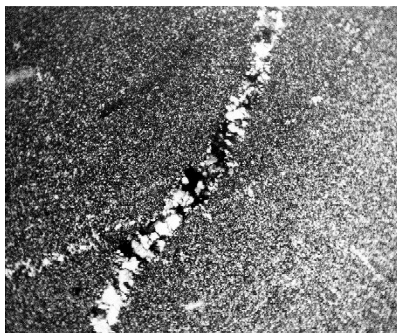
Рис. 3. Микрогранобластовая структура с размером зерен 0,005...0,015 мм. По трещинам перекристаллизации развитие гранобластовой структуры с размером зерен от 0,005...0,01 до 0,05...0,15 мм
