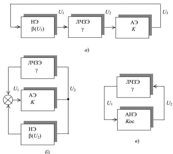
Рис. 1. Обобщенные блок-схемы колебательных систем генераторов
