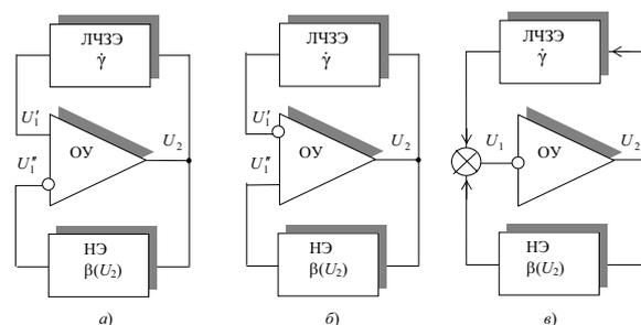
Рис. 2. Блок-схемы колебательных систем генераторов на ОУ
