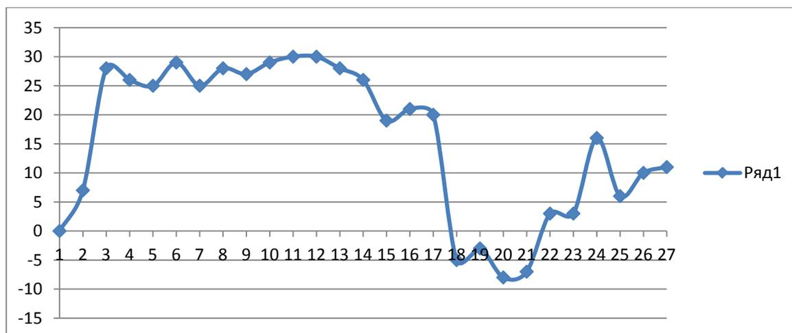
Рисунок 11. График отклонения от горизонтали наружного контура днища резервуара.
