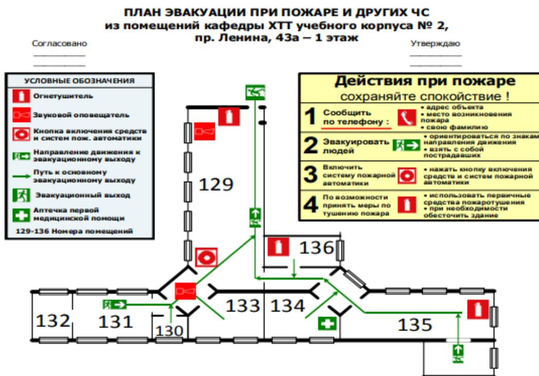
Рисунок 5.1 – План эвакуации производственного помещения с указанием средств противопожарной защиты
