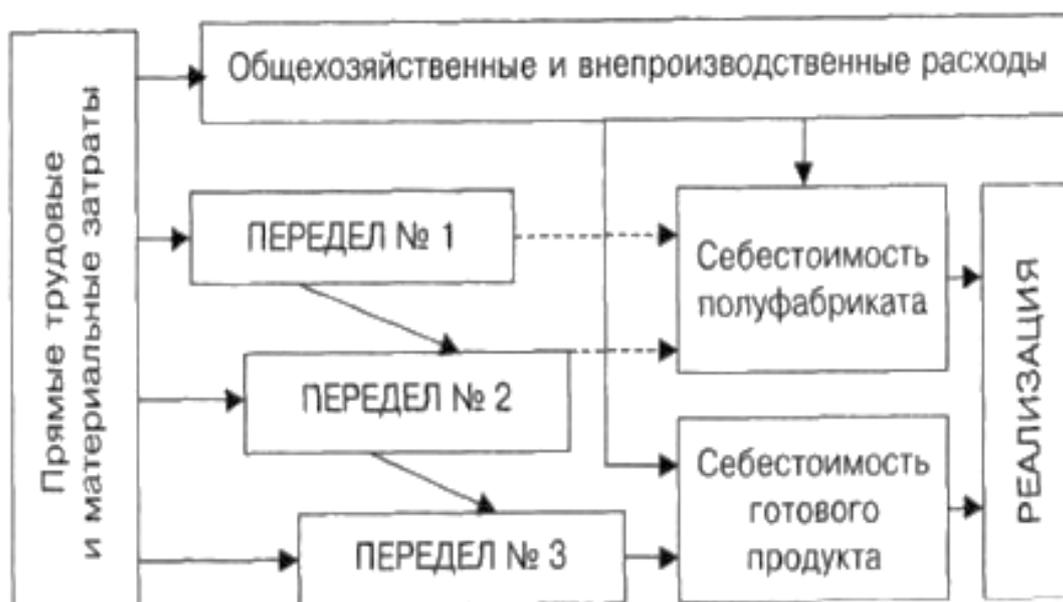
Рисунок 6 – Попередельный метод калькулирования
