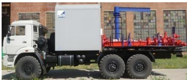
Рисунок 5 – БМ 70/32 с системой управления и контроля цементирования (СКЦ)
