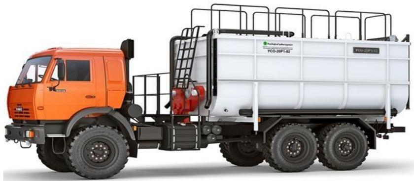
Рисунок 3 - Установка смесительная осреднительная УСО-20Р1
