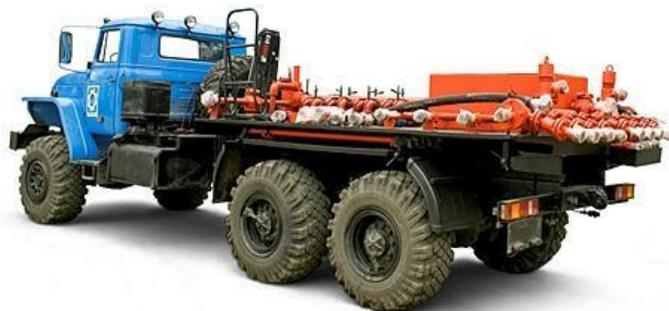
Рисунок 4 – Установка блока манифольдов БМ-70/32 на шасси Урал
