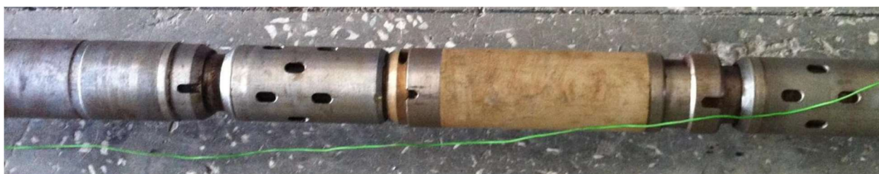
Рисунок 13 – Модуль бокового каротажа высокого разрешения БКВР-М2 [14]
