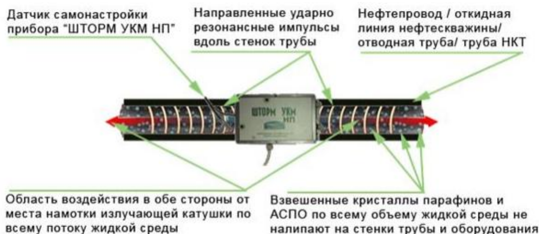
Рисунок 1.5– Принцип действия «ШТОРМ УКМ НП»
