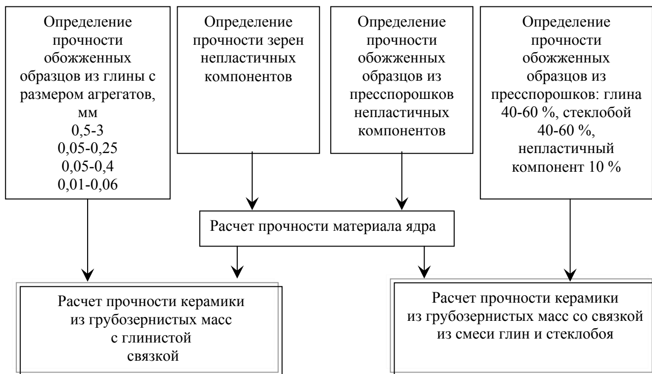
Рис. 4. Схема расчета прочности керамики из грубозернистых масс с учетом процессов в связке
