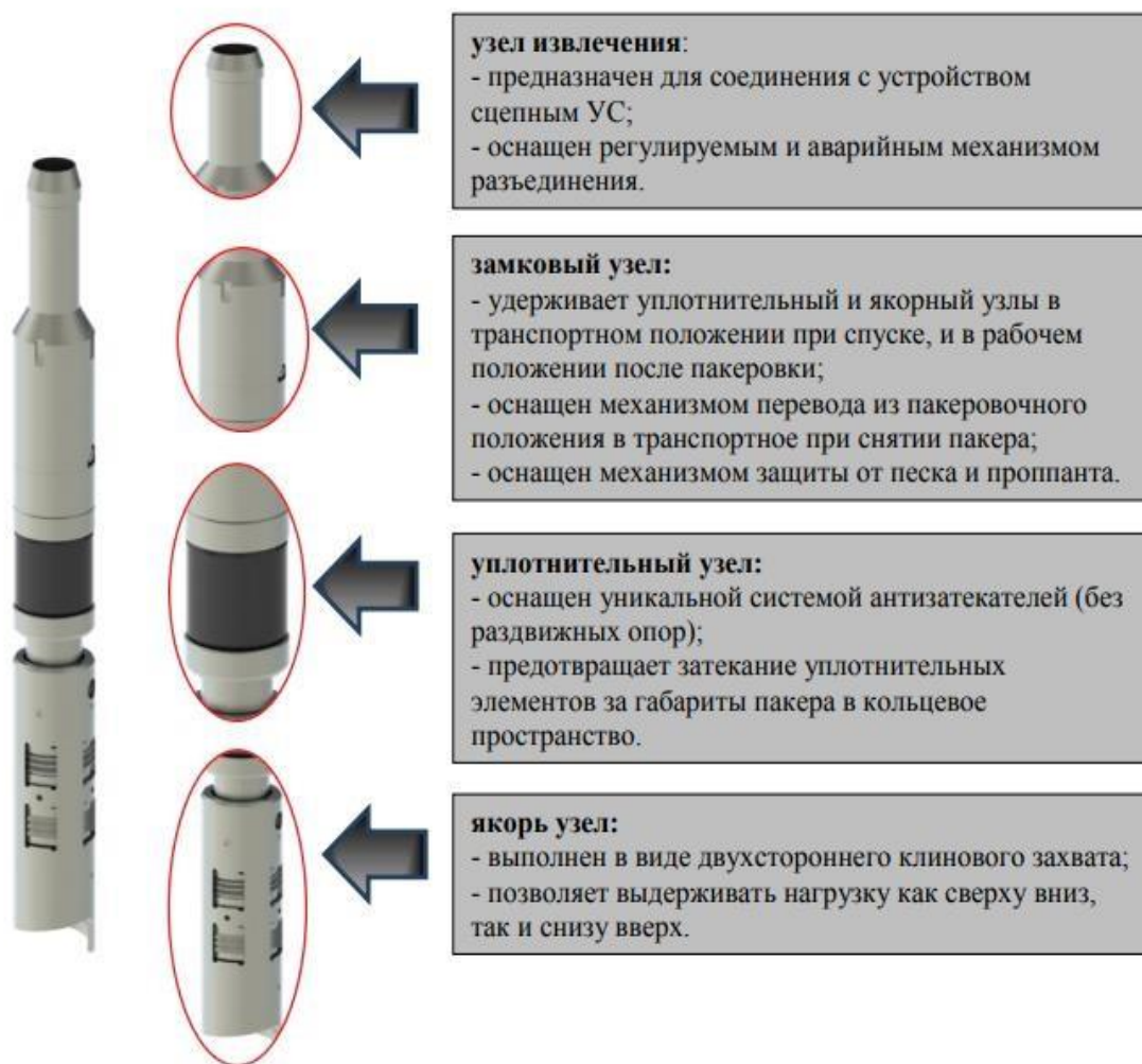
Рисунок 10 – Устройство пробки мостовой извлекаемой ПМ-И
