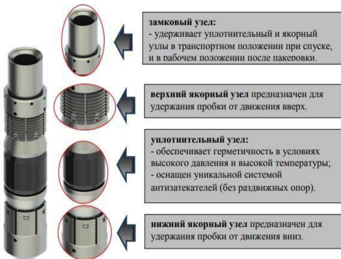
Рисунок 13 – Устройство пробки мостовой электромеханической ПМЭ
