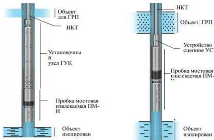
Рисунок 11 – Установка пробки типа ПМ-И и её извлечение
