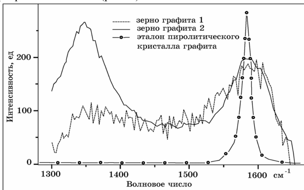
Рис. 7. Спектры КРС графитов Калгутинского месторождения. Спектрометр Romanor U1000, возбуждение линией 514,5 нм (мощность 150 мВ) излучением Ar-лазера (аналитик Шабанин А.П., ОИГТИМ СО РАН, г. Новосибирск)
