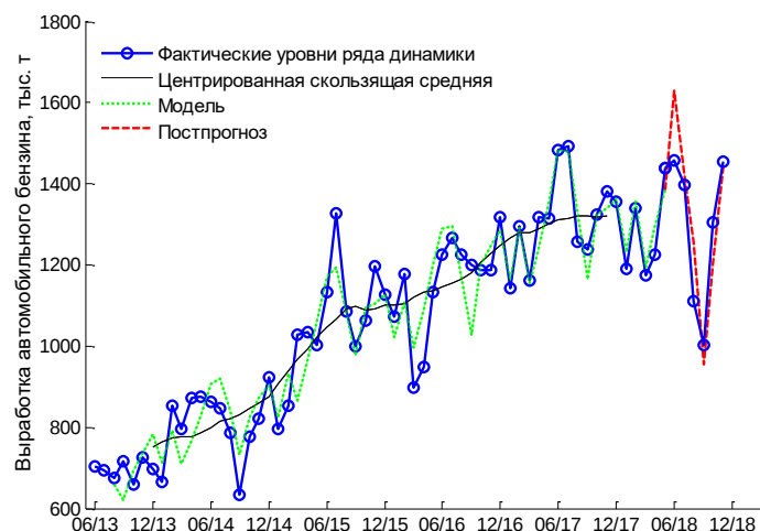
Рис. 2. Мультипликативная модель выработки автомобильного бензина К5 ПФО в виде произведения тренда ( T_4 ) и индексов сезонности (Index)
