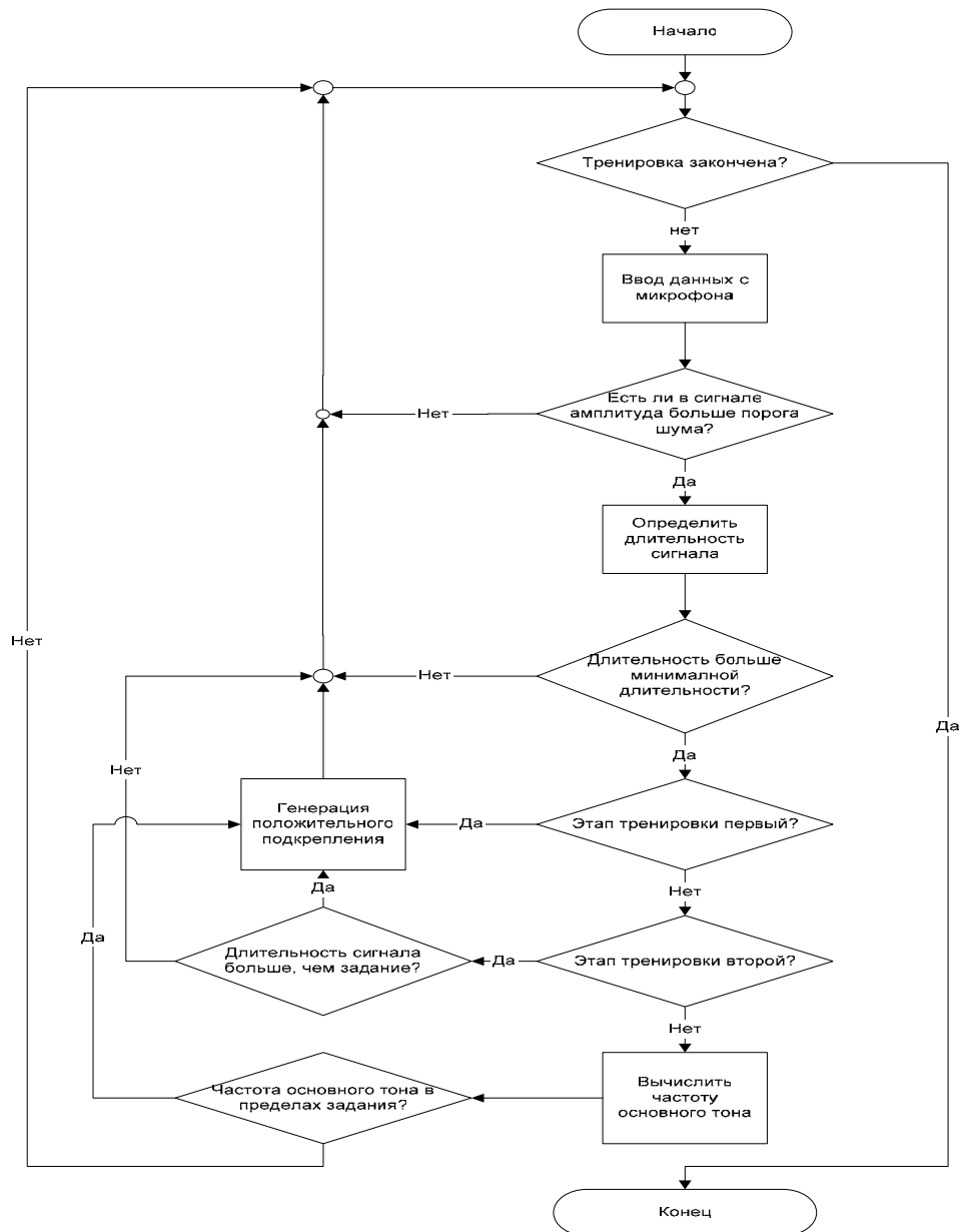
Рисунок 3. Блок схема алгоритма БОС-тренировок.
