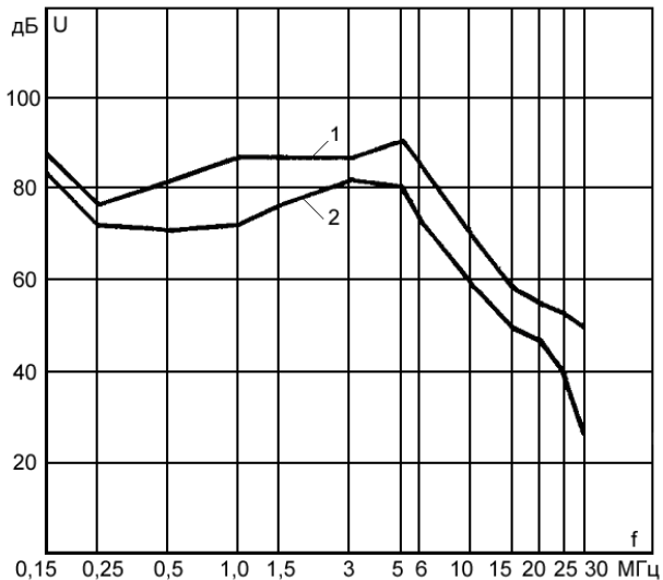
1 – базовый электродвигатель; 2 – с демпфированной обмоткой якоря Рис. 73. Напряжения радиопомех электродвигателя ПК 58-03-01
