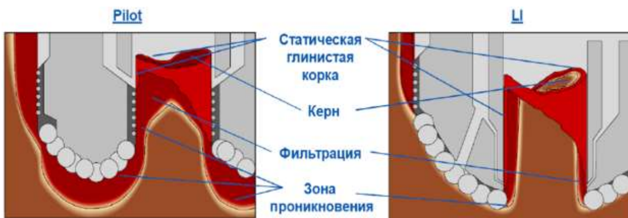
Рисунок 2.1. – Буровое долото с низким уровнем проникновения бурового раствора (LI) по сравнению со стандартным буровым долотом [31]
