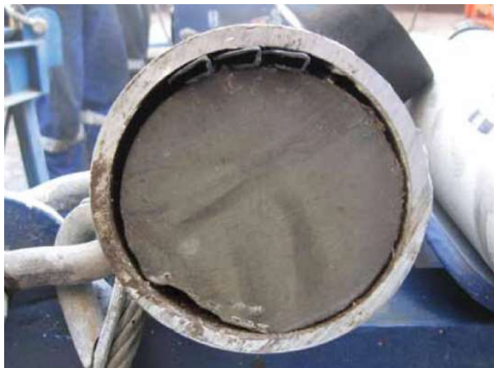
Рисунок 2.8 – Стабилизация керна по технологии Plastic Strip (Baker Hughes)
