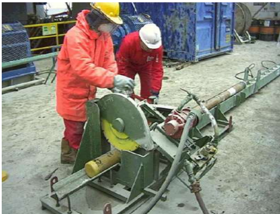
Рисунок 2.6 – Разрезание крновой трубы на дисковой пиле
