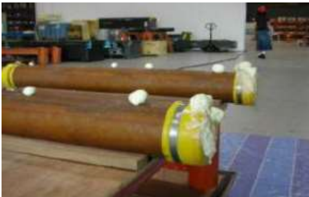
Рисунок 2.7 – Консервация керновых тубусов полиуретановой смолой.
