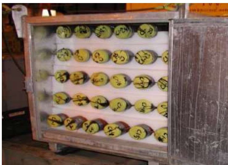
Рисунок 2.9 – Специальный ящик для транспорта керновых тубусов с демпфирующим наполнителем
