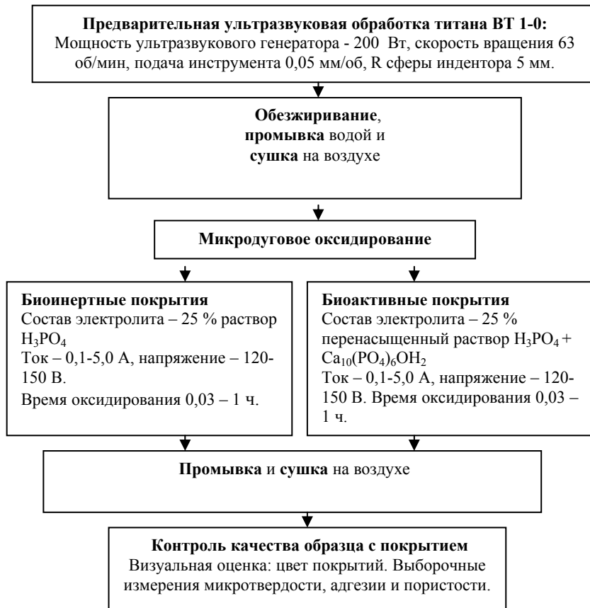
Рис. 17. Технологическая схема нанесения биоинертных и биоактивных покрытий методом МДО.
