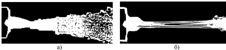
Рис. 3. Турбулентная (а) и ламинарная (б) плазменные струи.
