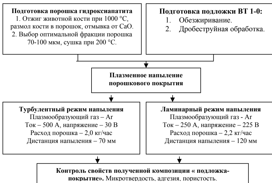
Рис. 9. Технологическая схема плазменного напыления биоактивных покрытий турбулентной и ламинарной плазменными струями
