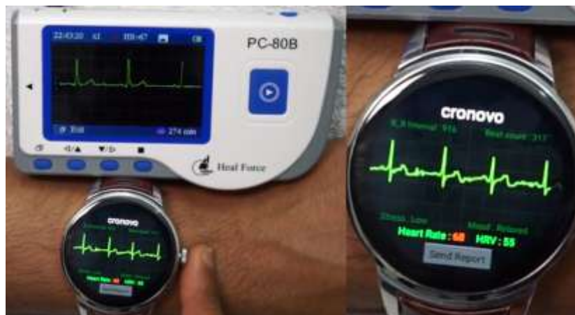
Рисунок 1.10 – Пример отведения ЭКГ при помощи трекера активности, где второй электрод встроен в кнопку
