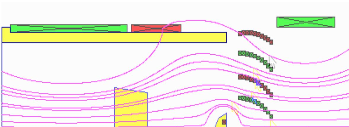
**Рис. 1. Распределение магнитного поля в дуговом испарителе и в области фильтра при включении дополнительной катушки, расположенной на выходе фильтра**
