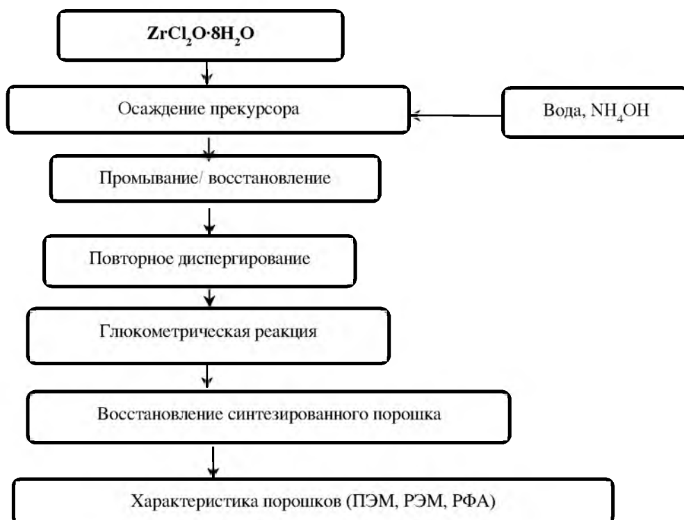
Рисунок 1.10 – Экспериментальная схема синтеза порошков диоксида циркония глюкотермическим методом [68]
