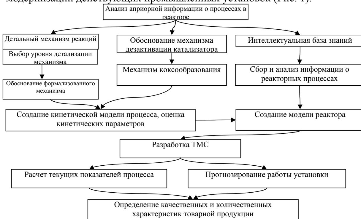
Рис. 1. Основные этапы моделирования процесса дегидрирования *n*-парафинов  $C_9-C_{14}$  на Pt-катализаторах
