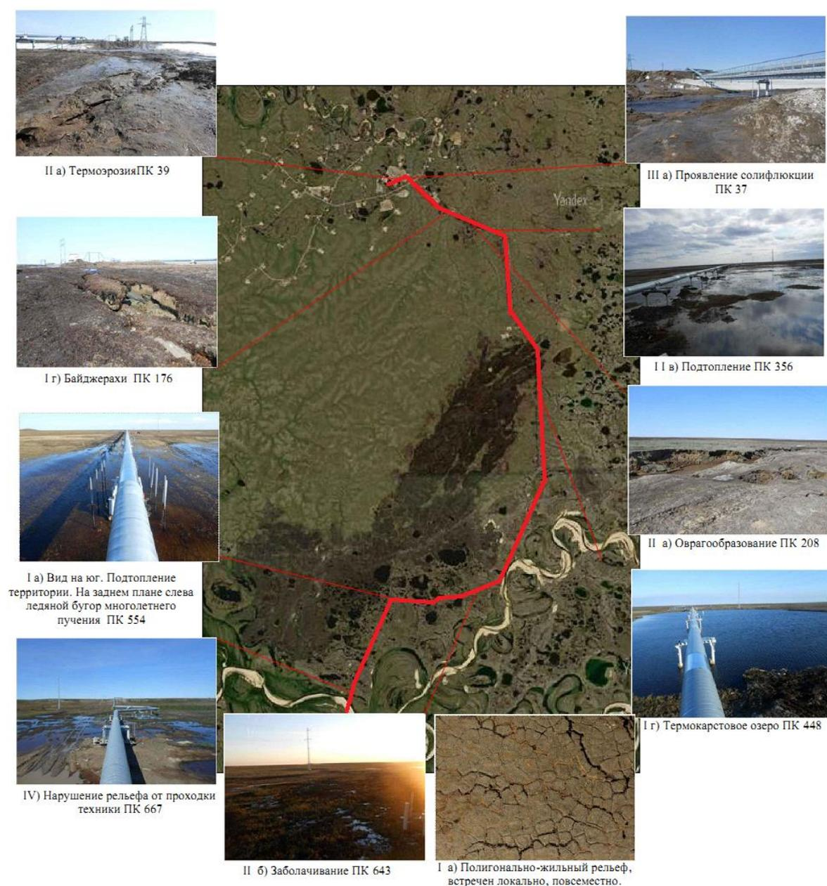
Рис. 1. Распространение геологических процессов по трассе
