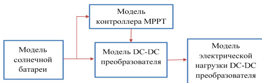
Рис.3. Обобщенная функциональная схема фотоэлектрической станции для построения математической модели
