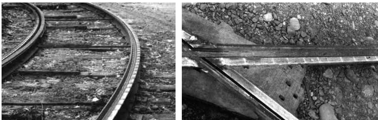
Рис. 6. Периодичность в расположении участков с повышенным износом рельсов.
