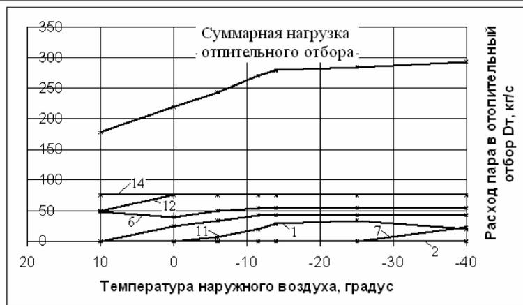
Рис.10. Оптимальная загрузка отопительных отборов турбин ТЭЦ  $P_0 = 8,8$  МПа в зависимости от температуры наружного воздуха:
