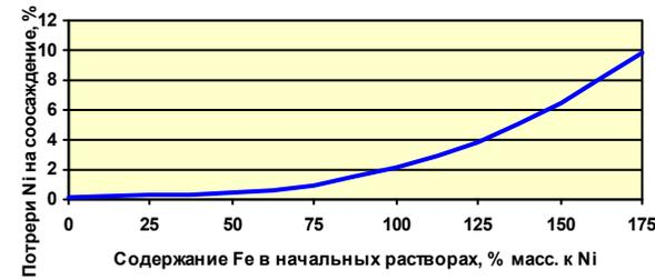
Рис. 2. Зависимость величины потерь Ni на соосаждение с первым железистым кеком от содержания Fe (% масс. к Ni) в исходном растворе (аммиачное осаждение).
