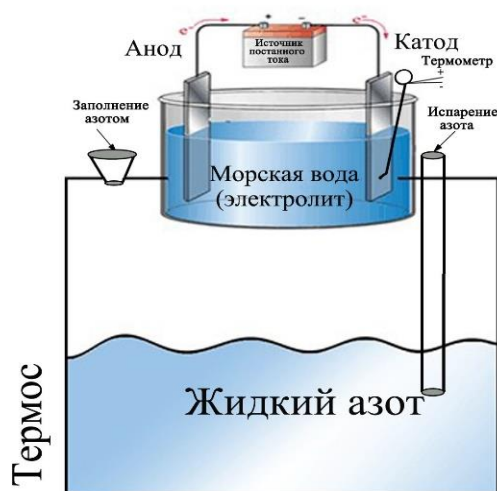
Рисунок 5.1 – Схема эксперимента по насыщению металлов из морской воды при пониженных температурах
