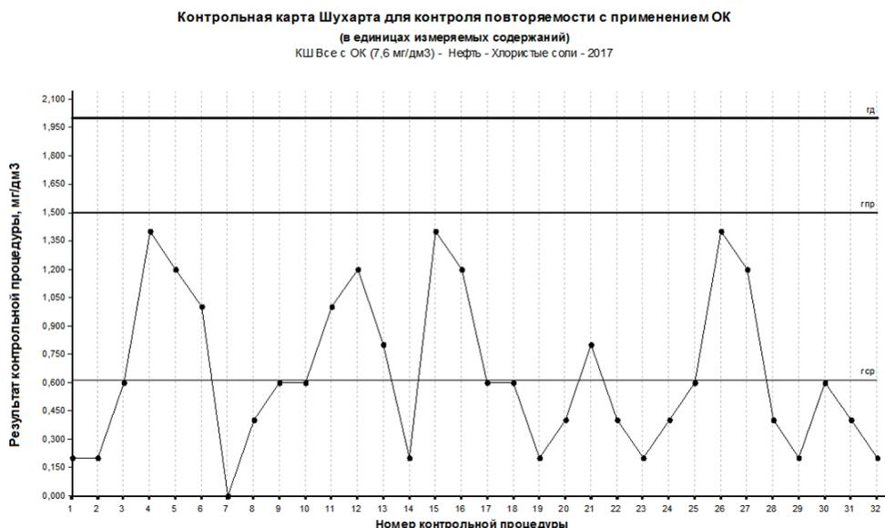
Рис. 4.44 в. Документ "Карты Шухарта повторяемости, внутрилаб. прецизионности, точности с ОК". КШ повторяемости, стр. 3
