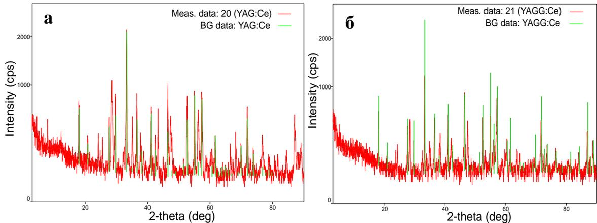
Рисунок – 7 Дифрактограммы образцов керамики YAG:Ce и YAGG:Ce
