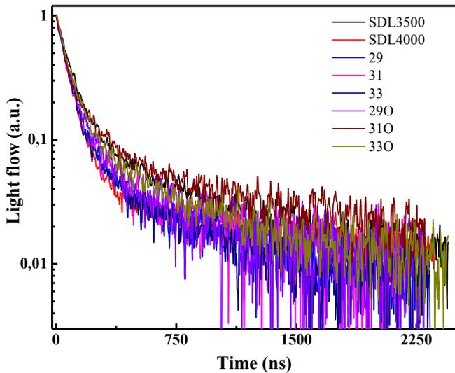
Рисунок – 13 Кинетические кривые затухания люминесценции промышленных и синтезированных в поле радиации (КЛ)
