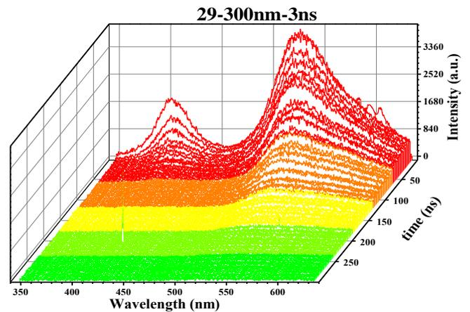
Рисунок – 12 Спектр люминесценции керамики при возбуждении на 300 нм
