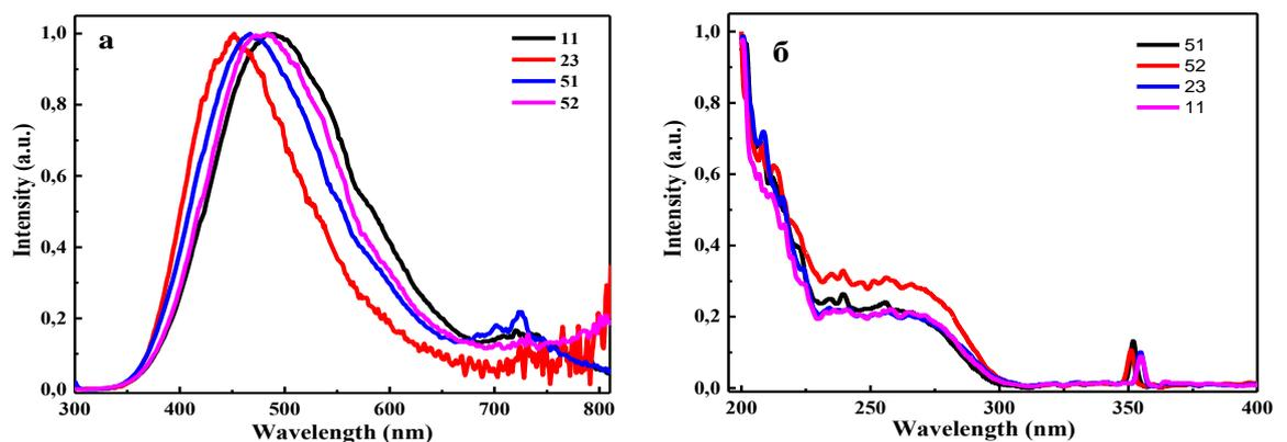
Рисунок – 3 Спектры люминесценции и возбуждения синтезированной керамики  $\text{MgF}_2:\text{W}$
