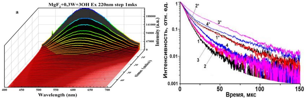
Рисунок – 4 Кинетика затухания люминесценции  $\text{MgF}_2:\text{W}$  керамики
