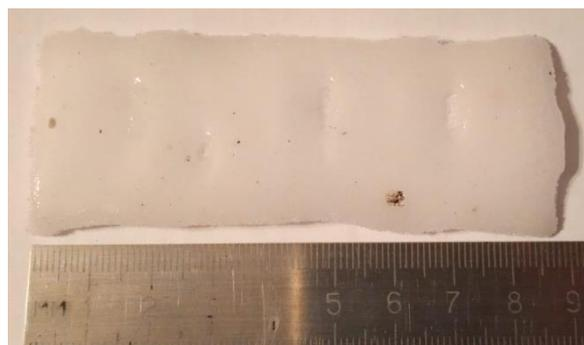
Рисунок – 1 Фотографии образца синтезированной керамики  $\text{MgF}_2$
