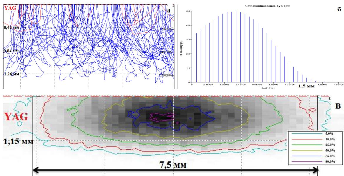
Рисунок – 14. Распределение потерь энергии потока электронов в YAG
