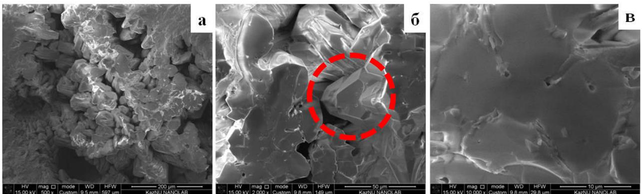
Рисунок – 6 СЭМ снимки в месте раскола образца 21 (YAGG:Ce) (а – 200 мкм, б – 50 мкм, в – 10 мкм)
