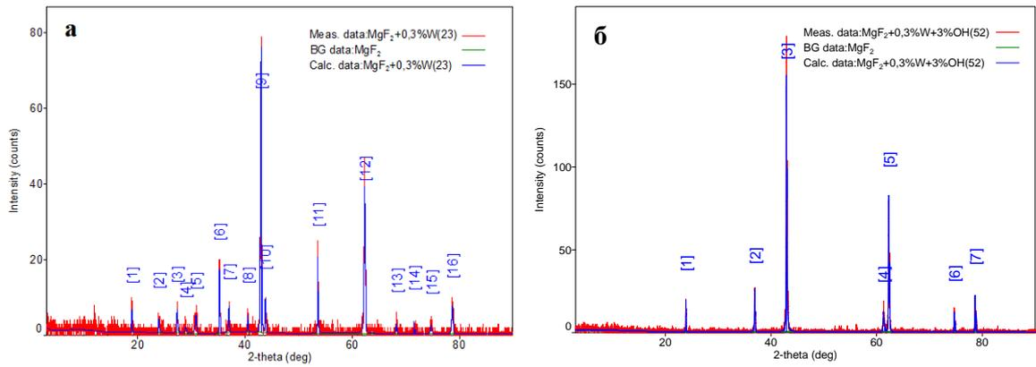
Рисунок – 2 Дифрактограммы образцов керамики  $\text{MgF}_2:\text{W}$
