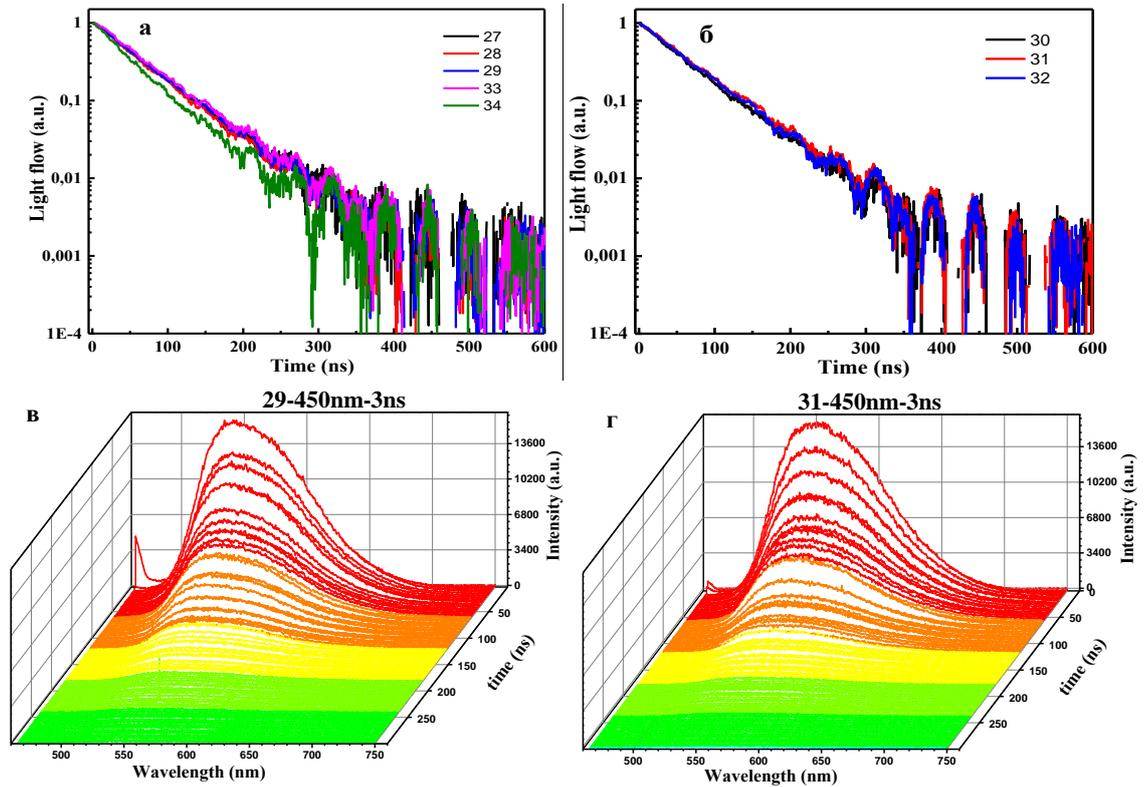
Рисунок – 11 Кинетика затухания люминесценции образцов YAG:Ce и YAGG:Ce при возбуждении 450 нм
