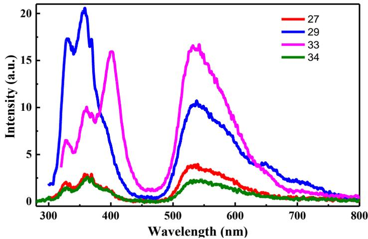
Рисунок 10 – Спектры люминесценции YAG:Ce керамики при возбуждении на 270 нм
