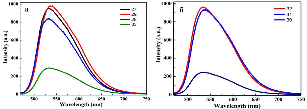
Рисунок 8 – Спектры люминесценции а – YAG:Ce и б – YAGG:Ce керамики при возбуждении на 460 нм
