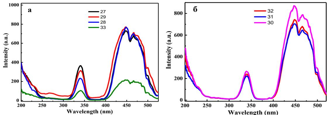
Рисунок 9 – Спектры возбуждения люминесценции а – YAG:Ce и б – YAGG:Ce керамики на  $\lambda = 540$  нм
