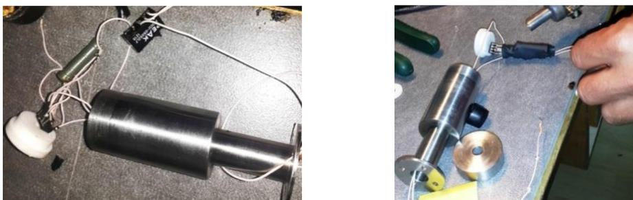
Рисунок 2.6 – Внешний вид конструкции пироболометра
