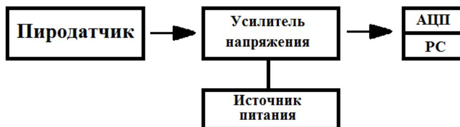
Рисунок 2.5 – Структурная схема регистрации пироболометра
