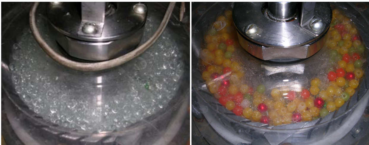
а) частицы d_s=3 мм, \rho_s=2500 кг/м 3 , б) частицы d_s=5 мм, \rho_s=1100 кг/м 3 .
