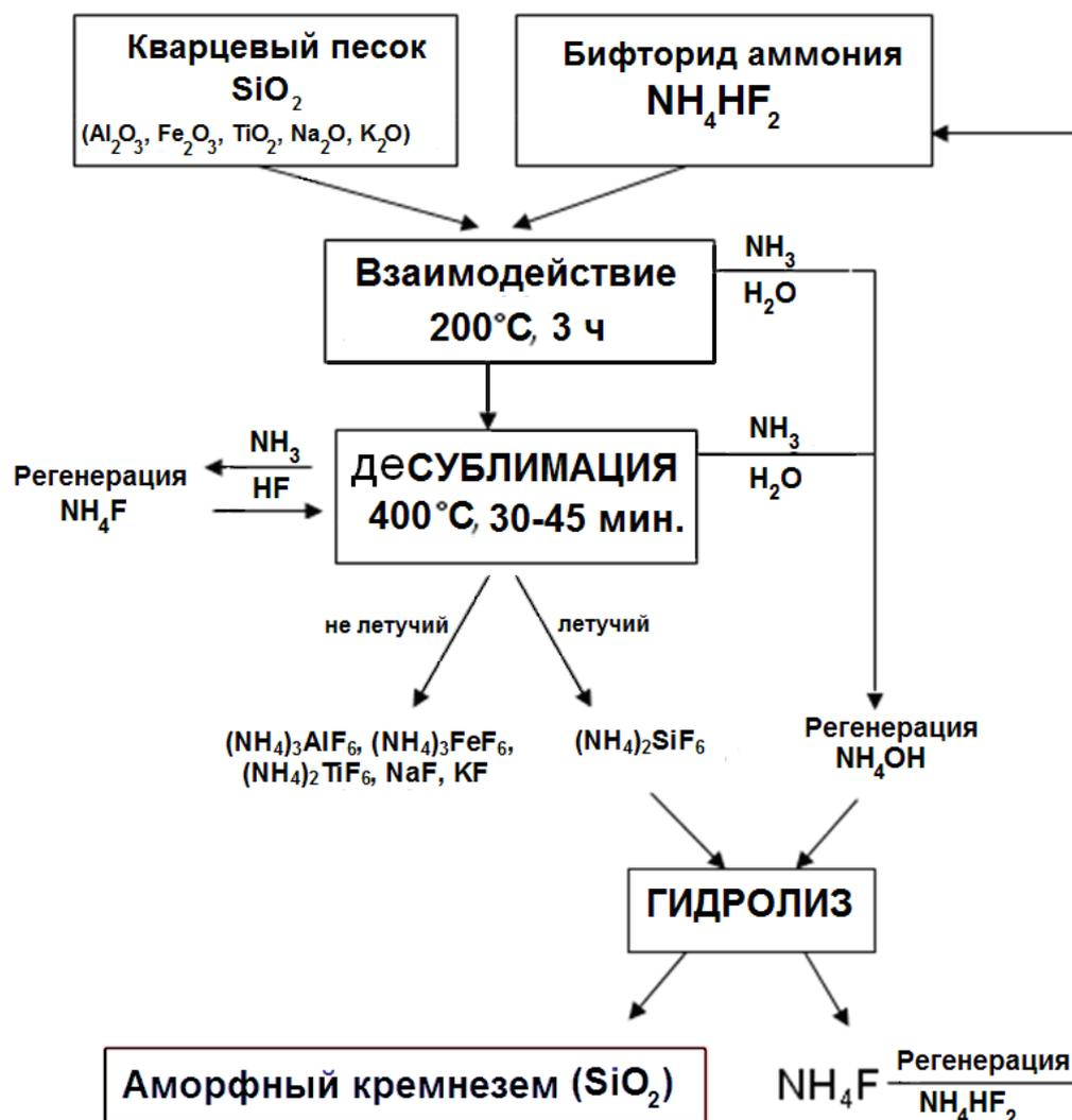
Рис. 8. Технологическая схема получения аморфного кремнезема из природных кварцевых песков Чалганского месторождения Приамурья.
