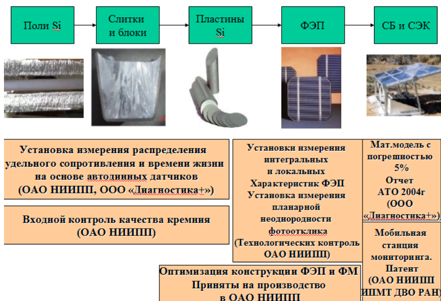
Рис. 12. Метрологический комплекс сквозного неразрушающего контроля на всех этапах производства и эксплуатации ФЭС
