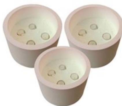
Рисунок 15. Образцы дисков из исходных смесей, помещенных в порошок из оксида алюминия в закрытый тигель из оксида алюминия
