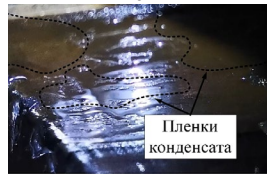
Рисунок 9 – Фотоизображения нижней поверхности верхней крышки конденсатора при T_{air} = 278 К в условиях подвода теплоты к испарителю от нагревательного элемента при T_h , К: а – 313, б – 333, в – 353, г – 373
