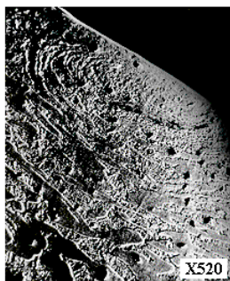
Рис. 2. Характер деформации бронзы АЖ 9-4 при циркуляционном трении
