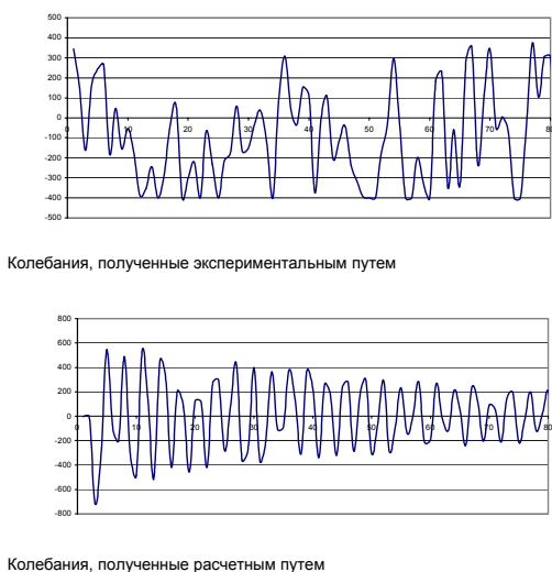
Рис. 19. Примеры ускорений обрабатываемого образца
