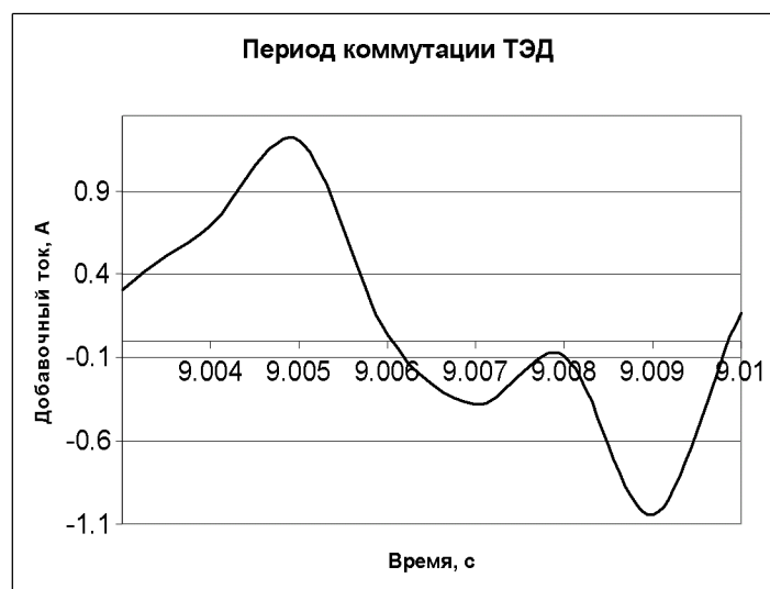
Рис. 4 Экспериментальные данные добавочного тока коммутации
