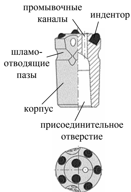
Рисунок 13 – Буровой инструмент безлезвийного типа
