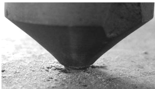
Рисунок 18 – Внедрение в породу одиночного индентора
