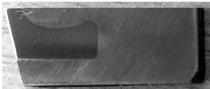
Рис. 11 Составная режущая пластина для отрезного резца
