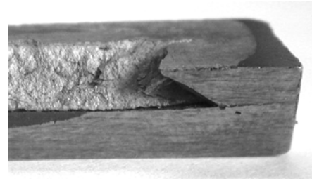
Рис. 2 Вид разрушения двухслойной пластины ВК8-Т30К4
