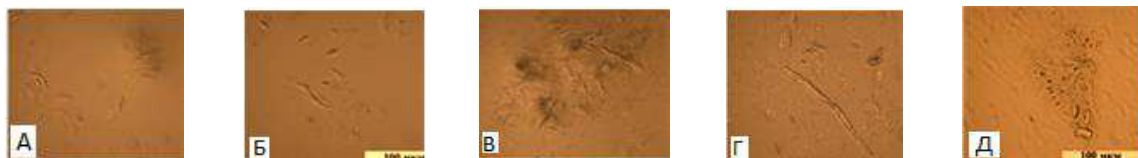
Рис. 4. Микрокристаллическая структура (А) ГК1, (Б) ГК2, смеси ГК:ГК2 в соотношении (В) 9:1, (Г) 7:3, (Д) 1:1
