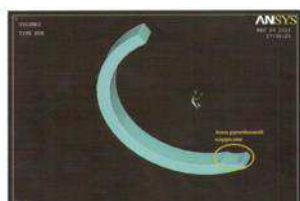
Рис.5 Модель половины трубы с коррозионным повреждением
