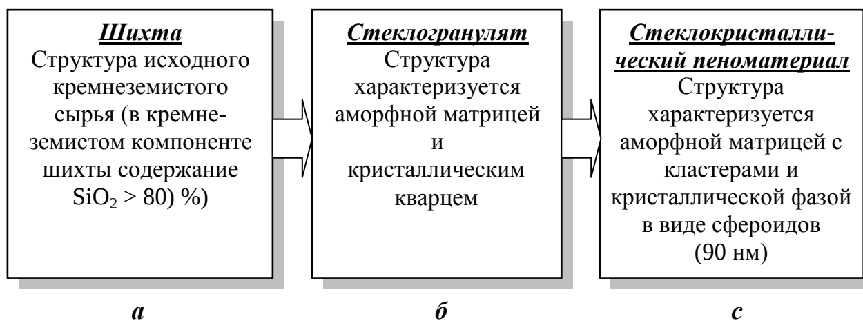
Рисунок 17 – Схема структурных превращений кварца ( \text{SiO}_2 ) при получении пеностеклокристаллических материалов из кремнеземистого сырья
