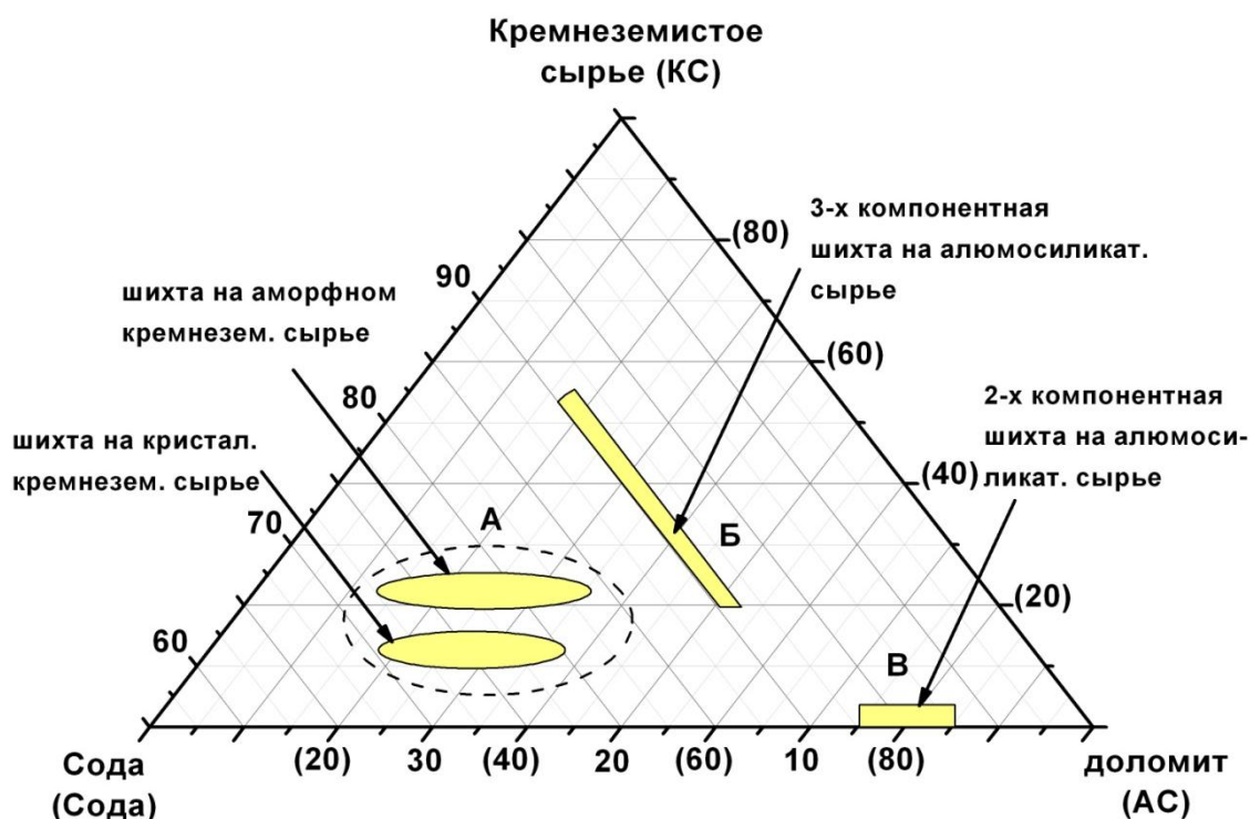
Рисунок 5 – Концентрационная диаграмма шихт на основе кремнеземистого (КС) и алюмосиликатного (АС) сырья для получения низкотемпературного стеклогранулята: А – область составов шихт в диаграмме КС – сода – доломит; Б – область составов шихт в диаграмме АС – КС – сода; В – область составов в диаграмме АС – сода
