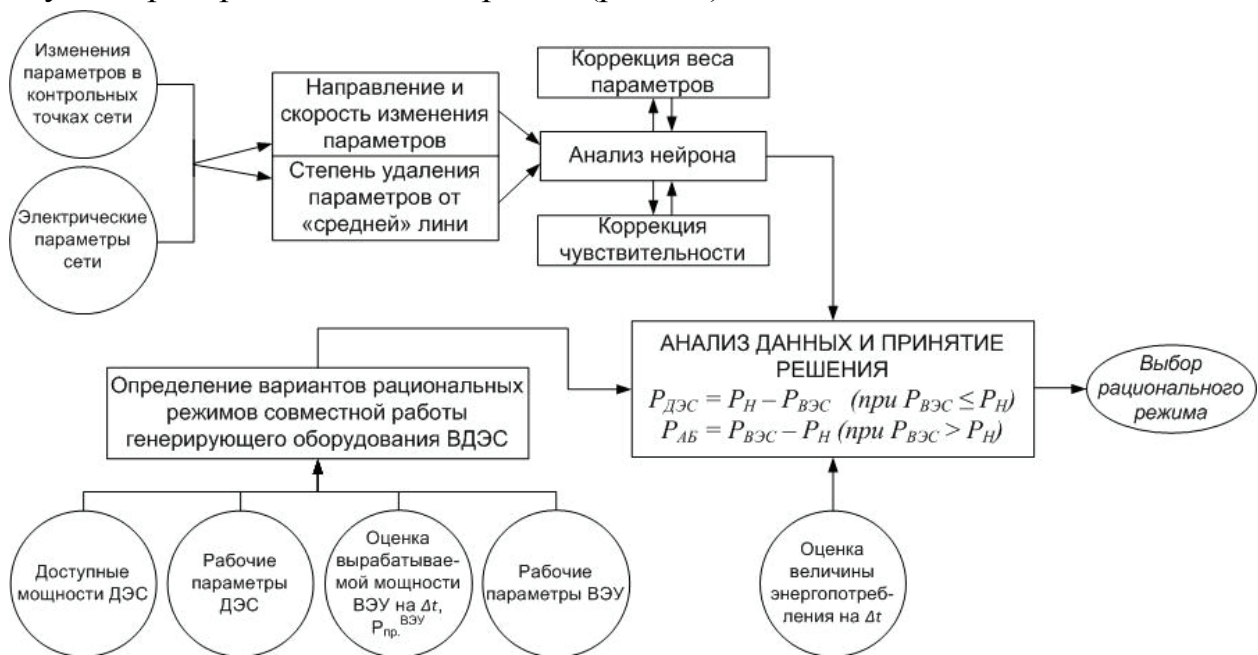
Рисунок 2. Структурная схема алгоритма согласования нагрузки ВДЭТК на основе нейронных сетей
