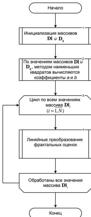
Рис. 4. Обобщенная схема алгоритма линейаризации
