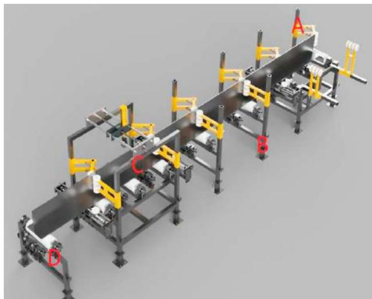
Рисунок 6 - Линия для лазерной сварки таврового соединения
