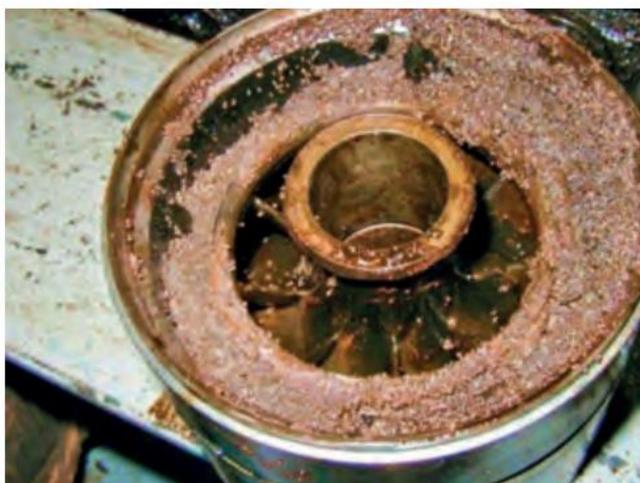
Рисунок 6 – Рабочая ступень электроцентробежного насоса, забитая пропантом вследствие обратного выноса наполнителя трещины в скважину
