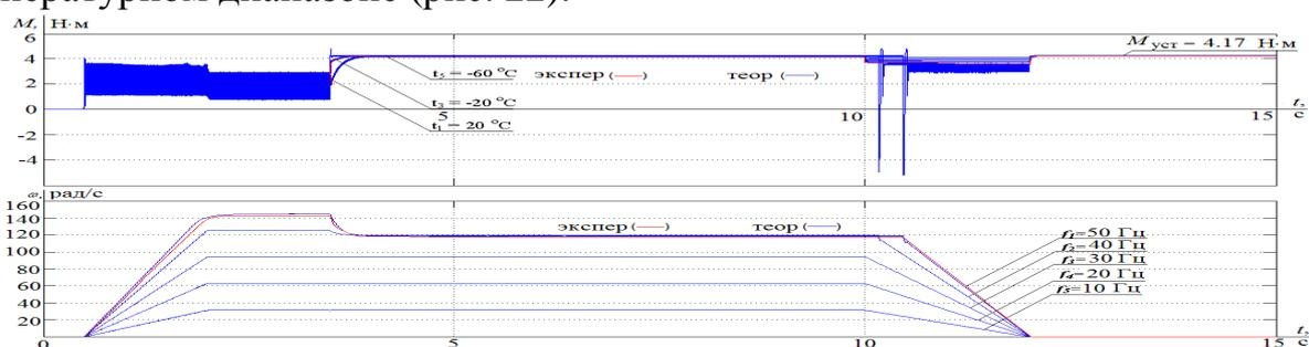
Рис. 22. Переходные процессы по моменту и скорости АД в диапазоне частот от 10 до 50 Гц, при разных значениях температур (от +20 до -60 °С)
