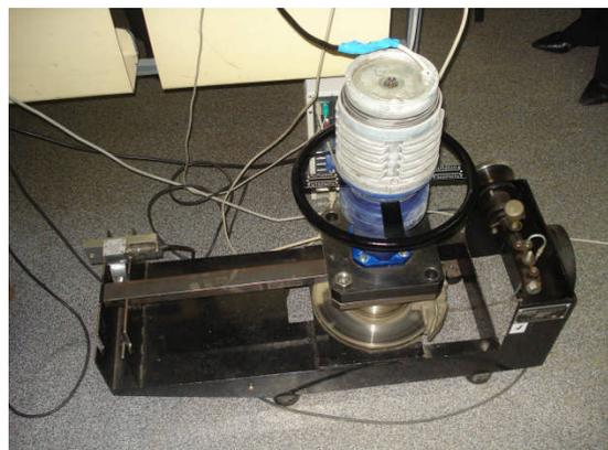
Рис. 21. Электропривод «ГУСАР» на испытательном стенде
